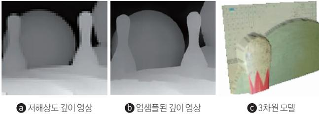
그림 3. 평면 맞춤을 이용한 깊이 영상 화질 개선 결과
