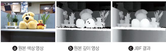
그림 4. 결합형 양방향 필터를 이용한 깊이 영상 화질 개선 결과
